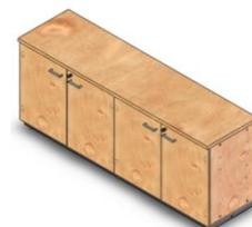
**Portas:** 04 (quatro), de abrir, com dobradiças tipo copo a 105o, em madeira mdp com 15 mm de espessura revestida em ambas as faces com laminado melamínico baixa pressão texturizado na cor a ser definida, bordas em poliestireno de 1 mm, com puxadores metálicos tipo alça, com fechadura.
