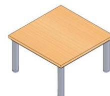
**PÉS:** 04 estruturas verticais. Em tubo de aço industrial redondo de 50,8 mm de diâmetro em chapa #16 (1,5mm) de espessura, com acabamento cromado ou em inox e com deslizador em material plástico.
