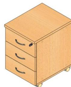
ESTRUTURA: Fundo, laterais e base inferior em madeira MDP de 18 mm de espessura, revestidos em laminado melamínico de baixa pressão texturizado em ambas as faces. Acabamento das bordas em fita de PVC de 1 mm de espessura, coladas a quente pelo sistema holt-melt, em todo seu perímetro. 04 rodízios sendo 02 com travas.
