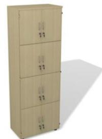
**ESTRUTURA:** Fundo em madeira MDP de 18 mm de espessura revestida em laminado melamínico de baixa pressão texturizado em ambas as faces. Laterais, base inferior e divisões centrais em madeira MDP de 18 mm de espessura (mínimo), revestida em laminado melamínico de baixa pressão texturizado em ambas as faces. Rodapé em aço, com sapatas reguladoras de nível, fixadas
