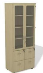
TAMPO INTERMEDIÁRIO Em madeira MDP de 25 mm de espessura, revestida em laminado melamínico de baixa pressão texturizado em ambas as faces. Borda frontal com acabamento em fita de PVC de 3 mm de espessura, colada a quente pelo sistema tipo holt-melt, com raio mínimo de 2,5 mm em todo seu perímetro. Bordas transversais e posterior com acabamento em fita de PVC de 1 mm de espessura, colada a quente pelo sistema tipo holt-melt em todo seu perímetro.
