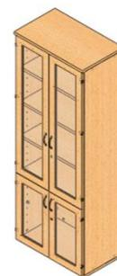
**TAMPO INTERMEDIÁRIO:** Em madeira MDP de 25 mm de espessura, revestida em laminado melamínico de baixa pressão texturizado em ambas as faces. Borda frontal com acabamento em fita de PVC de 3 mm de espessura, colada a quente pelo sistema
