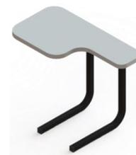
COMPONENTES METÁLICOS: Todas as peças metálicas recebem pré-tratamento de desengraxamento, decapagem e fosfatização, preparando a superfície para receber à pintura. Pintura epóxi-pó aplicada pelo processo de deposição eletrostática com polimerização em estufa com espessura média acima de 75 micras.
