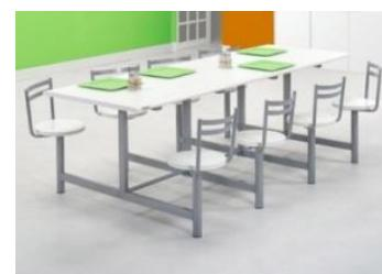
Estrutura da Mesa: em tubo 30 x 50 esp. x 0.9 mm com sistema de fixação ao tampo em chapa de aço de 50 x 70 mm, esp. de 1.9 mm, através de 04 parafusos por união auto atarraxante de 5 x 25 mm em fenda cruzada. Elemento de união entre a estrutura da mesa em tubo 1" x 1,2mm com sistema de encaixe macho-fêmea em chapa 50 x 55 x 2,65mm. Elemento de união dos bancos em chapa de aço 73 x 4.76 mm. Ponteira de PVC 30 x 50 mm, na cor preta e
